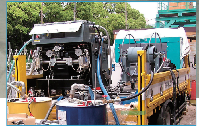
ポリウレア樹脂 スプレー施工システム車両(例) (ホース延長90m)
